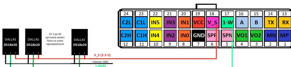
Рис. 7. Схема подключения термодатчиков с внешним питанием
