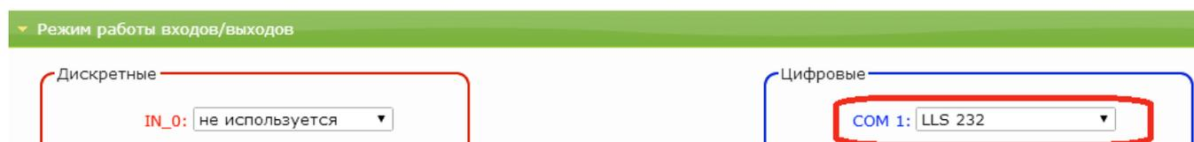
**Внимание:** При одновременном подключении цифровых ДУТ по RS485 и RS232 сетевой адрес 0 автоматически резервируется под ДУТ RS232, соответственно, нумерация ДУТ RS485 должна исключать адрес 0.
