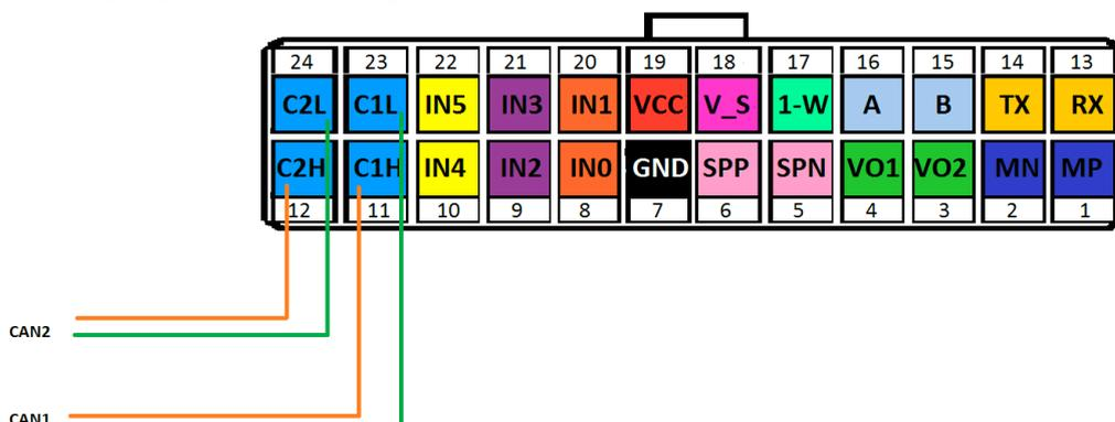
Рис. 6. Подключение CAN шины ТС напрямую к трекеру
