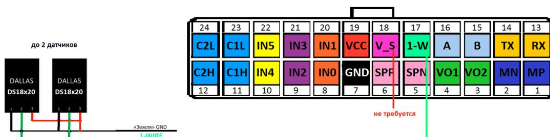
Рис. 8. Схема подключения термодатчиков без внешнего питания
