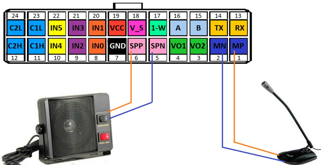
Рис. 11. Схема подключения микрофона и динамика
