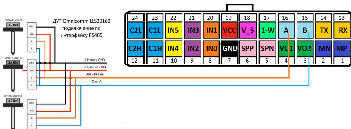
Рис. 3. Схема подключения нескольких ДУТ по RS485
