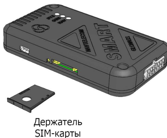
Рис. 21. Установка SIM-карты в устройство
