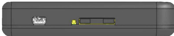
Рис. 2. Системный блок изделий SMART (вид сбоку 1). Разъем MiniUSB и гнездо держателя SIM-карты с выталкивателем
