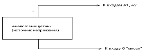
Рис. 16. Схема подключения аналогового датчика к входу I4 или I5
