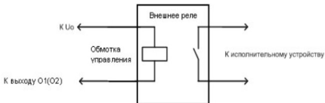
Рис. 23. Схема подключения внешнего реле к выходам устройства O1, O2 (выходы типа «открытый коллектор»)
