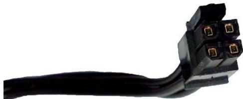
Рис. 9. 4-контактный кабель (жгут) типа Microfit-4
