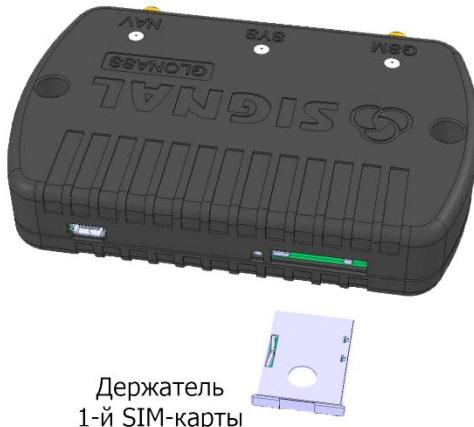
Рис. 24. Установка внешней SIM-карты в устройство
