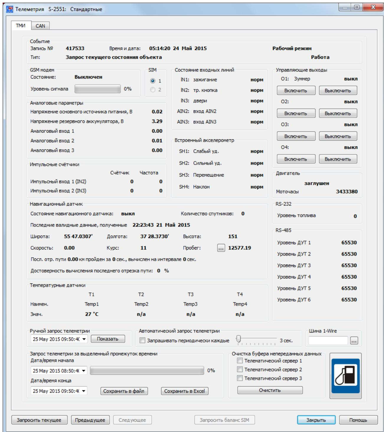
Рис. 55а. Окно просмотра текущей телеметрии и управления устройством. Вкладка «TMI» (для устройств S-2551 и S-2552)
