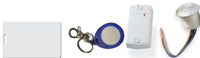
Рис. 43. Внешний вид Proximity-карт и брелоков и возможные варианты их считывателей
