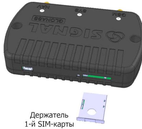
Рис. 24. Установка внешней SIM-карты в устройство
