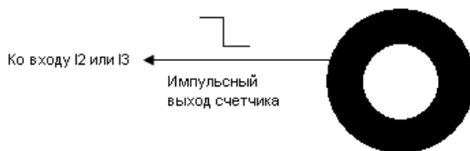
Рис. 13. Подключение импульсного датчика расхода топлива
